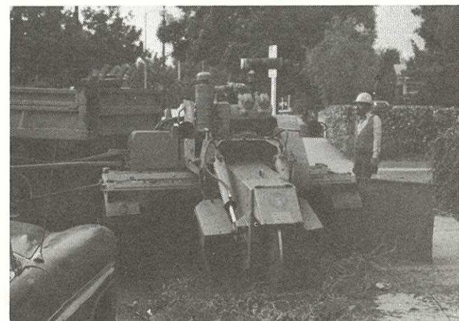
5. 作業中のスタンプカッター 南米アマゾンの開墾地で性能を実証している。
