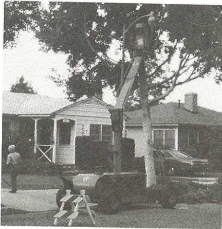
1. 自走式ワンマンリフト車 バケットに乗って操縦できる。
