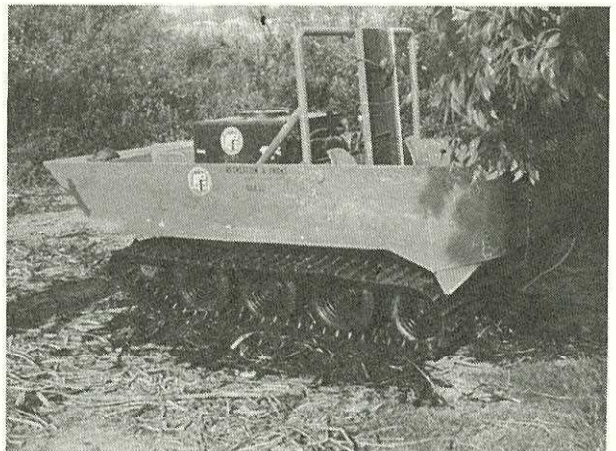
7. キヤタピラ車 水陸両用。まるでボート遊びでもしているように容易に作業ができる。
