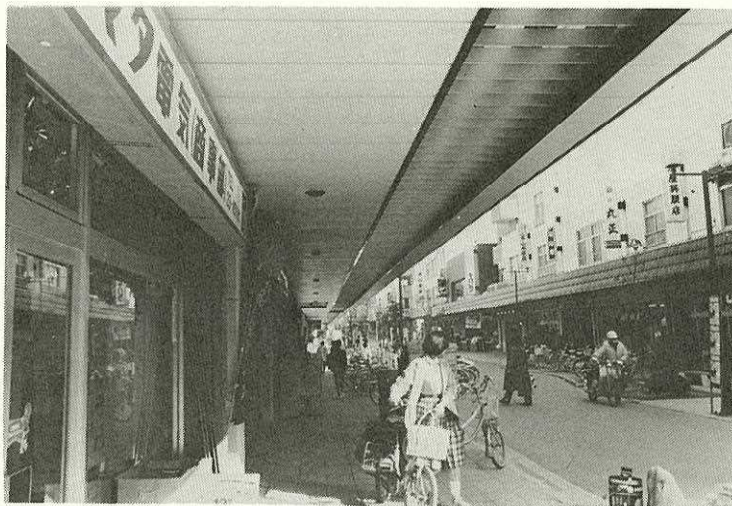
セットバックと柱のないアーケードで広々とした歩道 (中町ショッピングモール)
