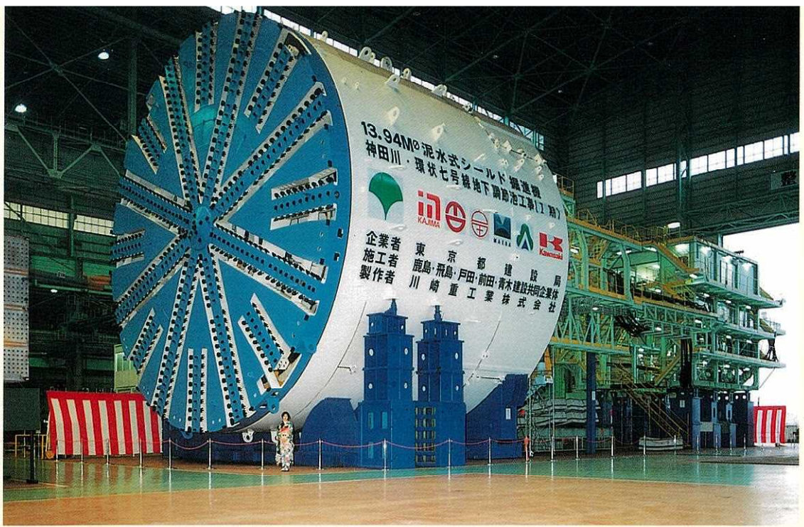
▲13.94Mφ泥水式シールド掘進機（神田川・環状七号線地下調節池用）
