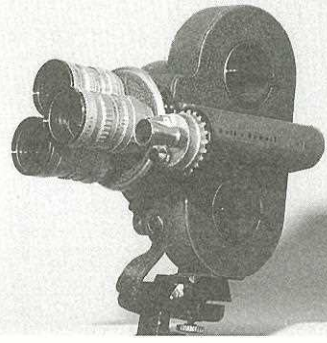
*アメリカ製(16ミリ)フィルモ70DR:かつてTVニュース用として活躍、ピント合わせは目測、ゼンマイ式のため災害時、僻地でも心配なし。土木現場取材のセカンダカメラに適す。
