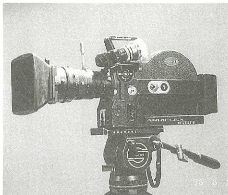
*ドイツ製（16ミリ）アリフレックスSR： 現在最も活躍中の機種。一眼レフ形式で操作性が特に 良い。最大11分の連続撮影が可能、カメラノイズがない ので同時録音にも適している。
