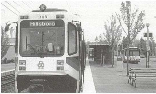
▲ポートランド(アメリカ)のLRT“MAX” 同一ホームでバスと乗り換えができる
