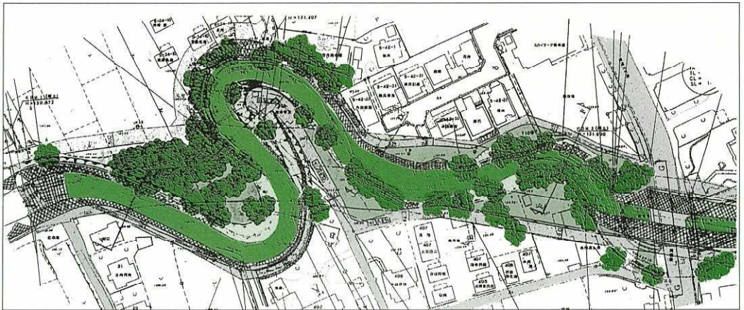
(C) 最終案。蛇行の内側を削って河積を確保。蛇行・河畔林・土岸が残る。
