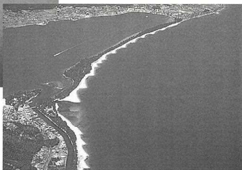
施工後（平成2年） ▼ 小突堤群は回復した砂浜で覆われている
