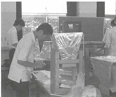
生徒一人ひとりがアルミホイールを使ってソーラークッカーを製作
