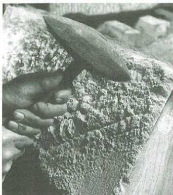
右・小叩き仕上げ 道具は「両刃」 左・つつき仕上げ 道具は「トンボ」 下・ノミ切り仕上げ 會澤氏は左利きのため、右手でノミを持っている
