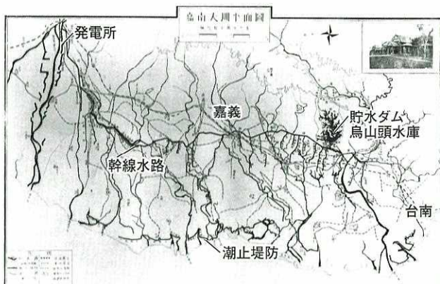
嘉南平原に巡らされた水路と土木施設（嘉南農田水利会提供） 工事では、1万6000kmの水路と分水門、水路橋、ダム発電所、潮止堤など4000の施設をつくった。
