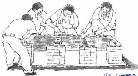
④レンガ積み/十分に水に浸したレンガをモルタルと交互に積む。レンガの重さでモルタルがつぶれないように、1日3段くらいを目安とする。
