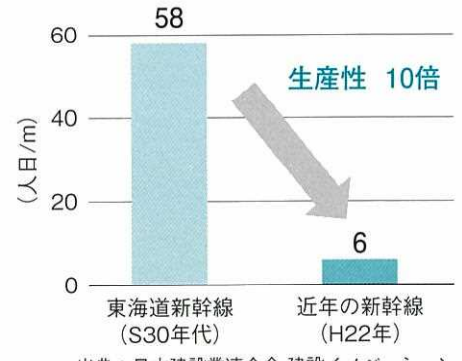
出典：日本建設業連合会 建設イノベーション 図1. トンネル工事におけるトンネル1mあたりに要する作業員数
