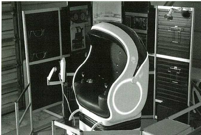
写真2. タワークレーン遠隔操作用コックピット
