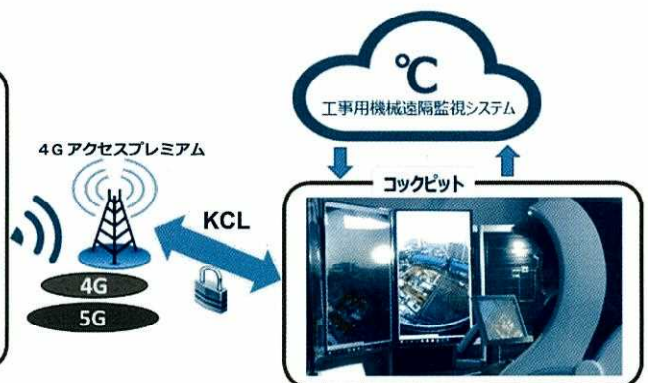
図4. タワークレーン遠隔操縦の概要
