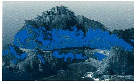
データを用いた法面抽出
