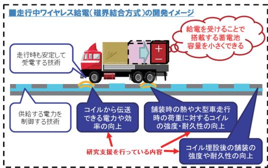
図-2 走行中ワイヤレス給電技術のイメージ (磁界結合方式)
