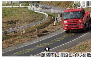
写真-1 走行中ワイヤレス給電技術の実験状況
