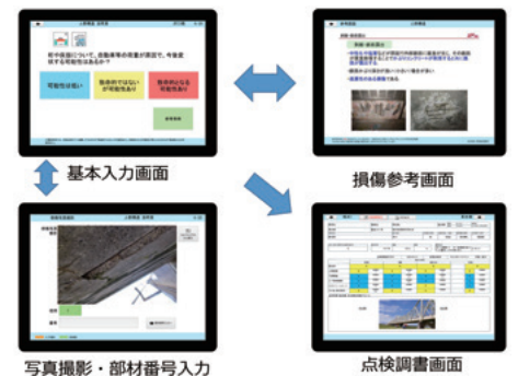
図8 タブレット端末を利用した橋梁点検システム
