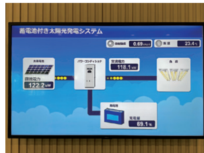
太陽光発電の状況が確認できるディスプレイ
