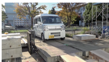
図4 省力型たわみ計測に関する実験状況
