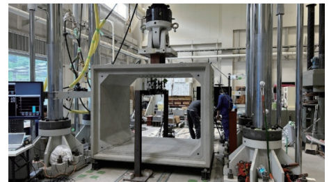
図6 ボックスカルバートの破壊実験
