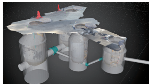
図8 マンホール内を点群化、3Dモデリングした画像
