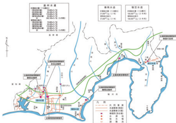
図1 静岡県水道用水供給事業概要図
