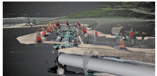
図7 VIRTUAL SHIZUOKA・管路の点群データ・3Dモデルを同時展開した画像
