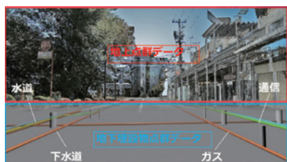
図21 地下埋設物の可視化イメージ
