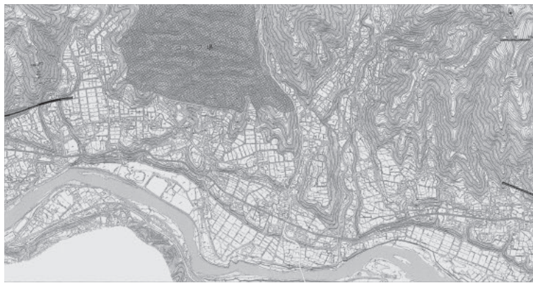
図表2.バイパスルートの選定に用いた航空測量図(s=1:2,000)
