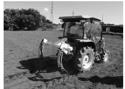
・約60cmの深さまで耕す（硬盤を破碎、亀裂をつくり、土をリフレッシュ） ・トラクターに専用の農業機械を装着し、農業者が実施
